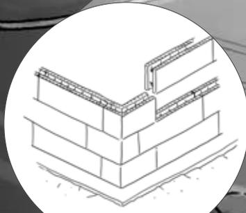
Nudura供地基和墙系统用途的隔热混凝土模板（ICF）比传统框架更坚固，隔热功效更佳而且可以在更低温度下安装。
